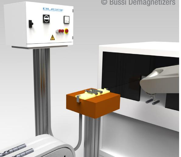
在线安装在使用机器人传送部件的自动化过程中的消磁机：
