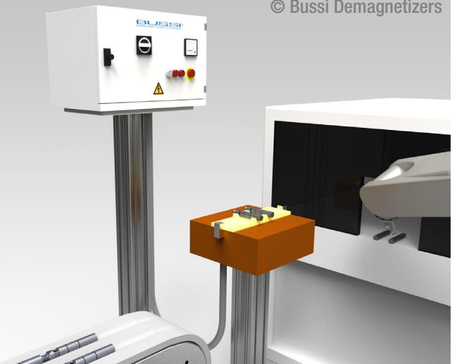
Entmagnetisierer prozeßgekoppelt in automatisierte Vorgänge mit Roboter:
